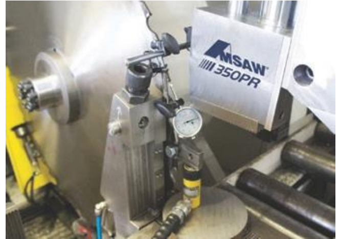
图2：液压容器在锯片是施加的切向力和位移通过百分表测量。
