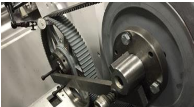
图1：锁定变速箱的输入轴，防止转动。
