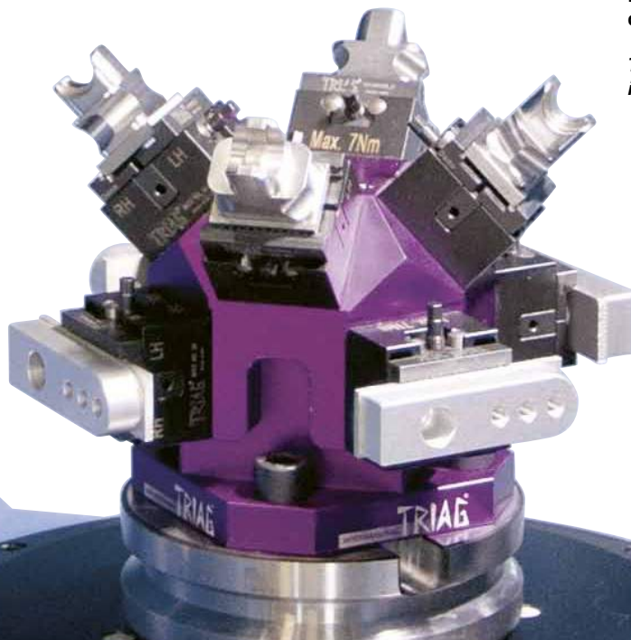
Mehrfachspannung auf Sputnik 1 Multiple workholding on Sputnik 1
