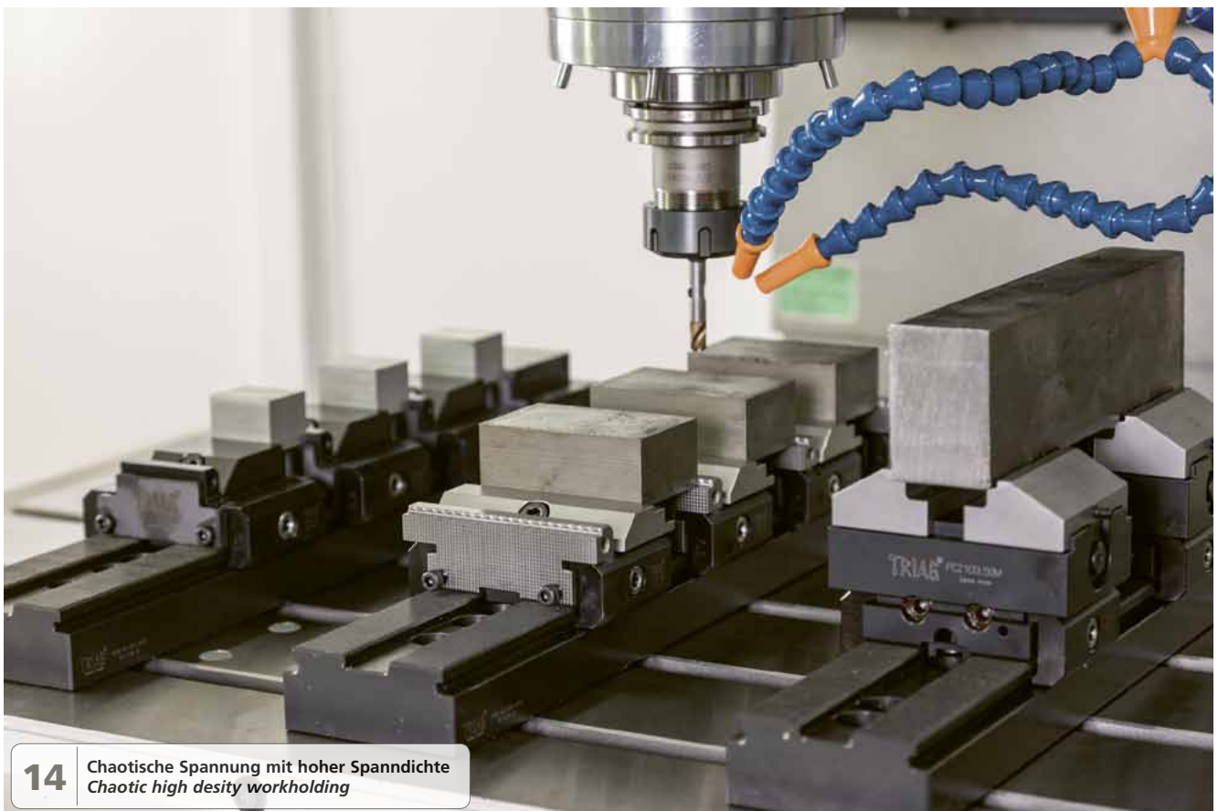
13 Chaotische Spannung mit hoher Spanndichte Chaotic high density workholding
