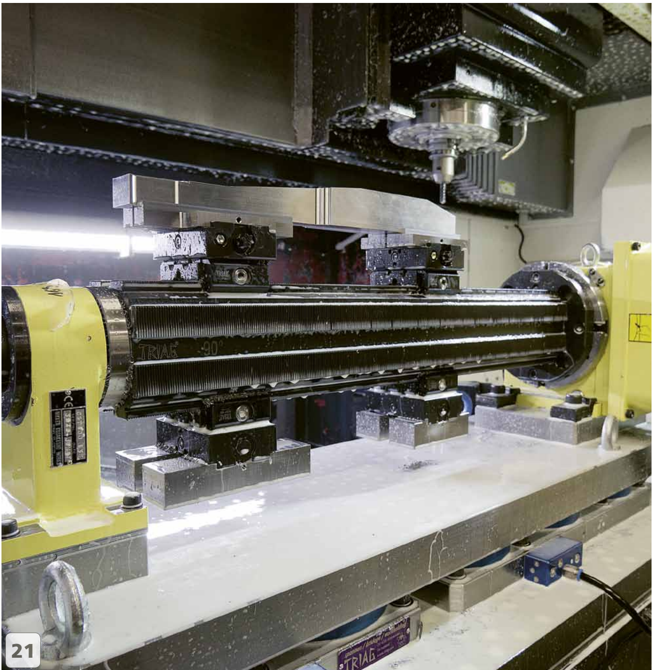
20 5-Achs Anwendung auf Lehmann Teilapparat 5-axis application on Lehmann indexer
