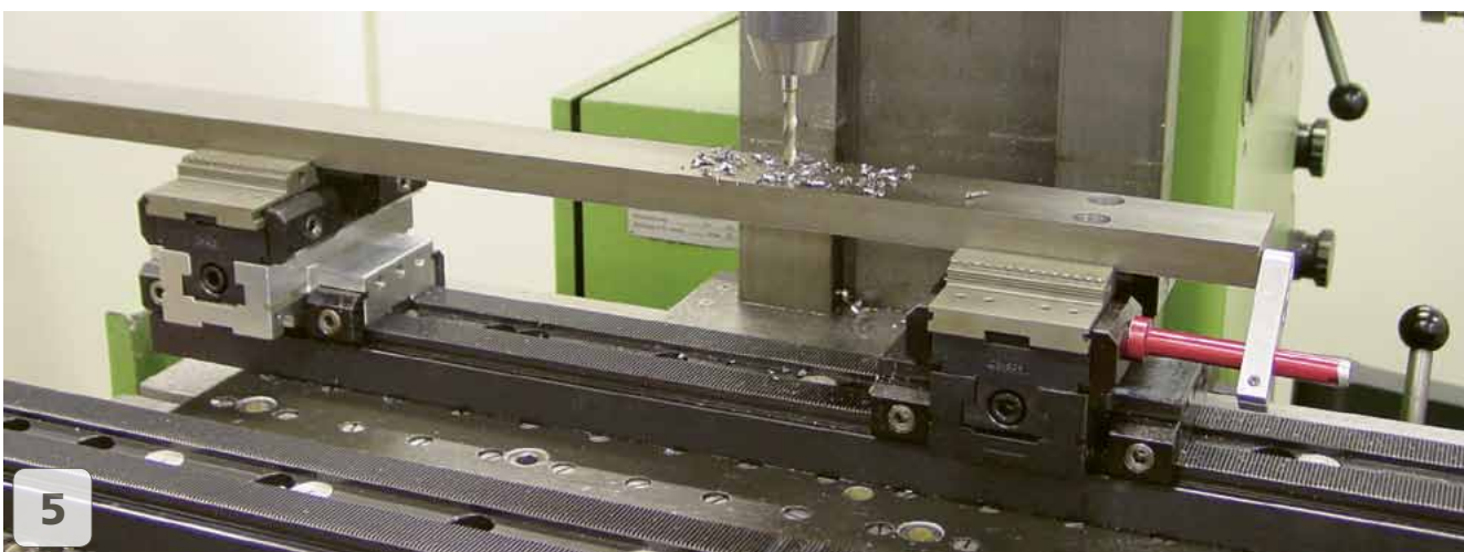
3 Zentrischspanner Self centring vise
